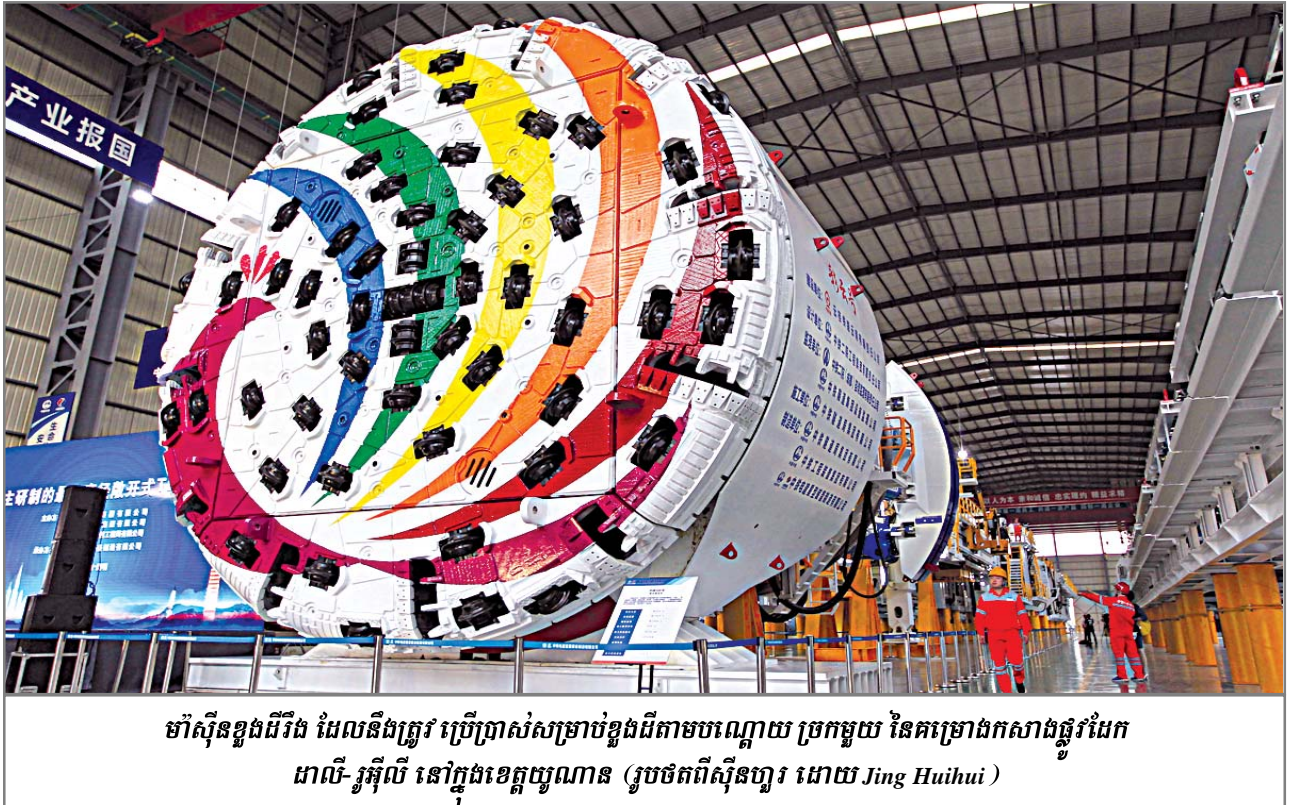
ម៉ាស៊ីនខ្នងជីវីង ដែលនឹងត្រូវ ប្រើប្រាស់សម្រាប់ជីករូងដីតាមបណ្តោយ ច្រកមួយ នៃគម្រោងកសាងផ្លូវដែក ម៉ាស៊ីន ខ្នងជីវីង នៅក្នុងខេត្តយូនណាន (រូបថត ដោយ Jing Huifui)
