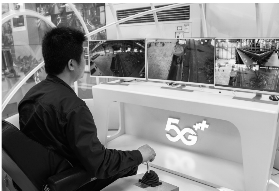
在湖南湘潭华菱湘钢五米宽厚板厂转炉车间转炉主控室，工作人员正在“5G+ 智慧天车远程操控台”上远程操作废钢吊运智慧天车。新华社 图
